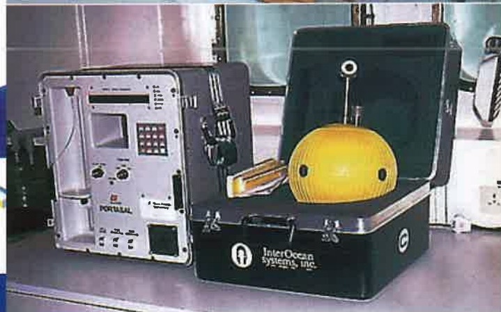
Alat current meter digunakan oleh Cawangan Hidrografi TLDM untuk mengukur kelajuan arus.
